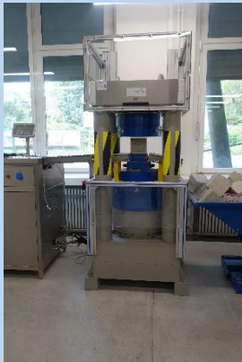
Betonblock wird mit Druck auf die Festigkeit geprüft
